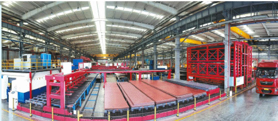
在星邦智能二期工厂的智能化下料生产线，搭载MOM系统的中控台与激光机器人联动作业，大幅提升结构件的稳定性和生产效率。长沙晚报全媒体记者 邓迪 摄
